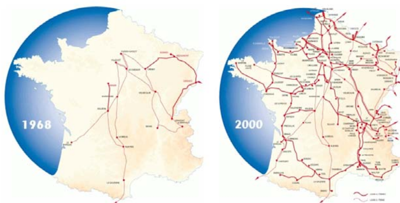
Figure 5. Architecture du réseau 400 kV français en 1968 (gauche) et 2000 (droite) 1 .
